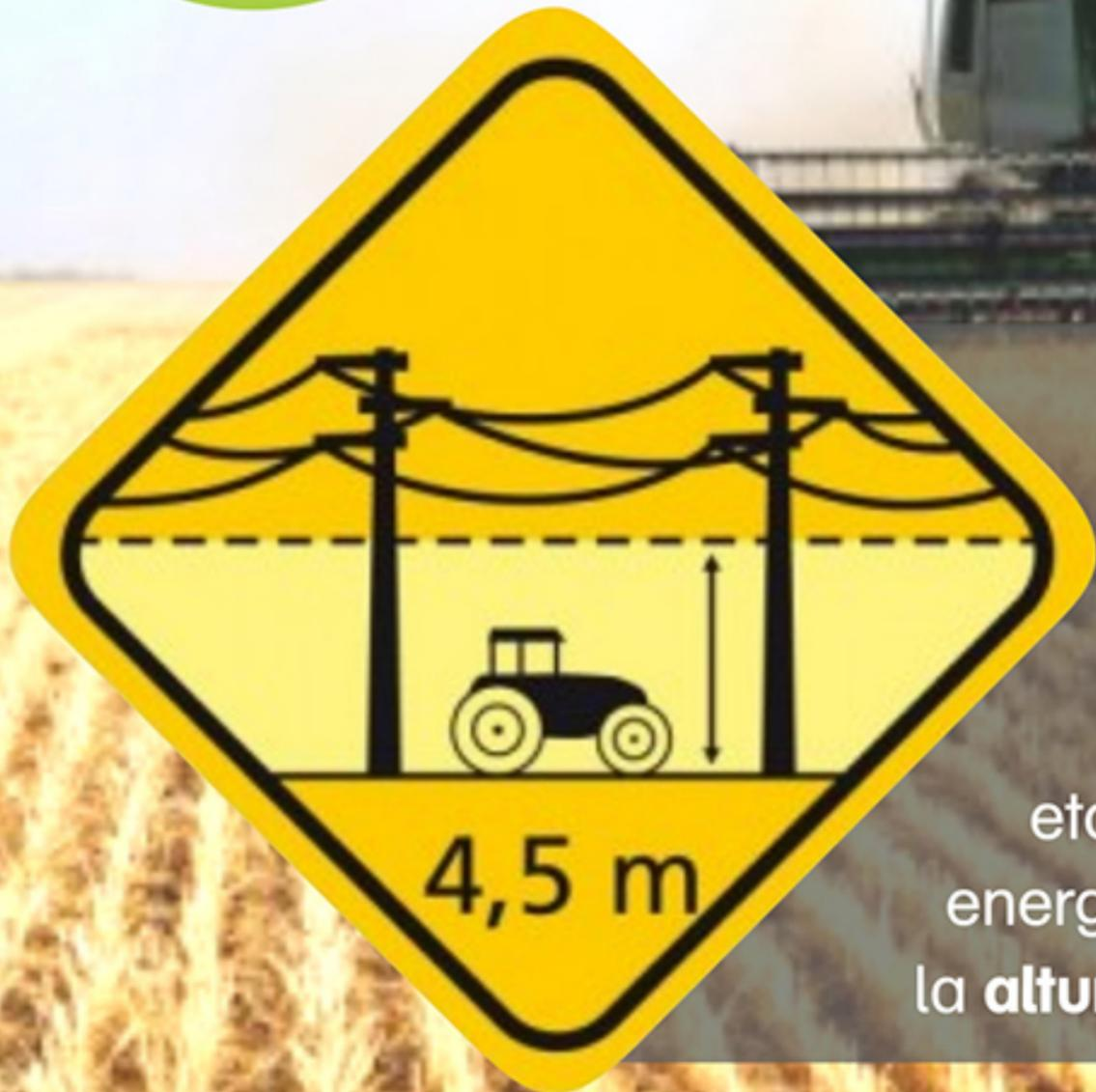
Cuando transite o realice tareas con maquinarias rurales, cosechadoras, tractores, fumigadores, etc., debajo de las líneas de energía eléctrica, evite superar la **altura máxima de 4,5 metros.**
